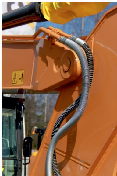
Металлическая спираль серии СМ является наиболее распространенным видом защиты на территории Российской Федерации в силу исторических предпосылок. Изготавливается из нескольких видов проволоки: оцинкованной, нержавеющей, которые выбираются в зависимости от условий эксплуатации оборудования и размера бюджета. Металлическая защита устанавливается на рукав непосредственно при изготовлении РВД, предназначена для защиты от механических повреждений (ударов, истирания).
